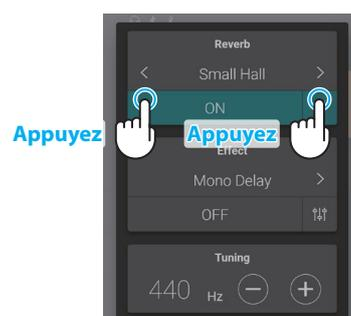
3. Dans la zone Reverb, appuyez sur le bouton [↑↓] pour afficher des options supplémentaires de contrôle du temps et de la profondeur.
