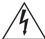
L'éclair avec une flèche à l'intérieur d'un triangle équilatéral est destiné à attirer l'attention de l'utilisateur sur la présence d'une « tension dangereuse » non isolée à l'intérieur de l'appareil, pouvant être suffisamment élevée pour constituer un risque d'électrocution.
